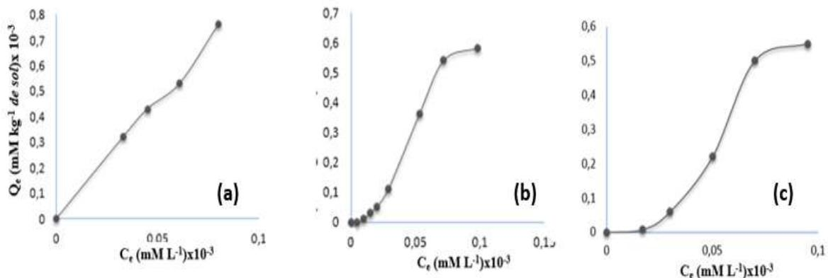
**Fig. 7:-** Courbe d'isotherme d'adsorption du colorant AB74 sur les différents sols.
