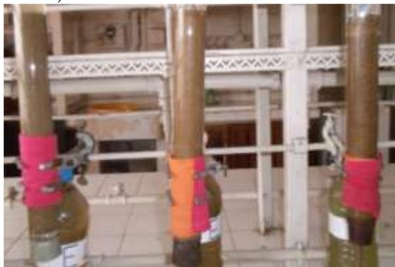
**Fig. 1:-** Colonnes de verre utilisées pour les tests (hauteur : 40cm ; diamètre interne : 4cm).
