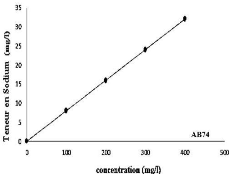
Fig. 4:- Courbe d'étalonnage du sodium à partir de la solution du colorant AB74.
