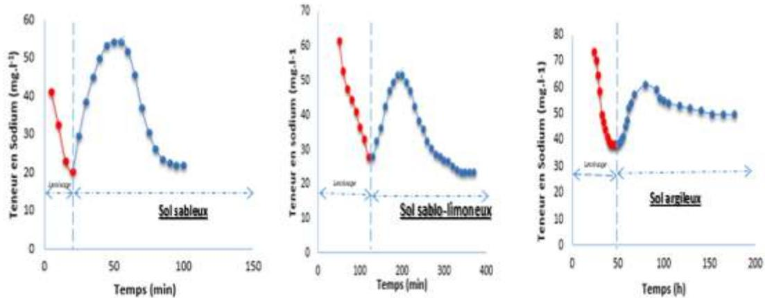
**Fig.6:-** Resultats des tests de lixiviation du colorants AB74 (400mg L<sup>-1</sup>) sur les différents sols.
