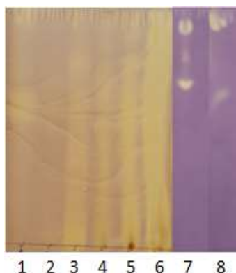
Figure 6:- Photo du profil chromatographique de composés antiradicalaires. Révélateur : DPPH, Observation : visible.
