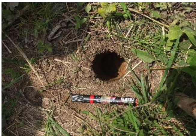
Figure 2 : Echantillonnage du sol sur le site expérimental dans la profondeur de 0-20 cm à l'aide d'une tarière Edelman
