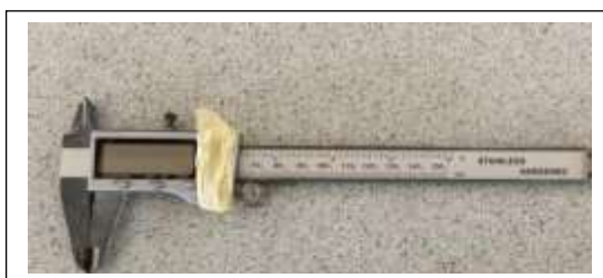
Figure 3 : Pied à coulisse (Précision 0,01).
