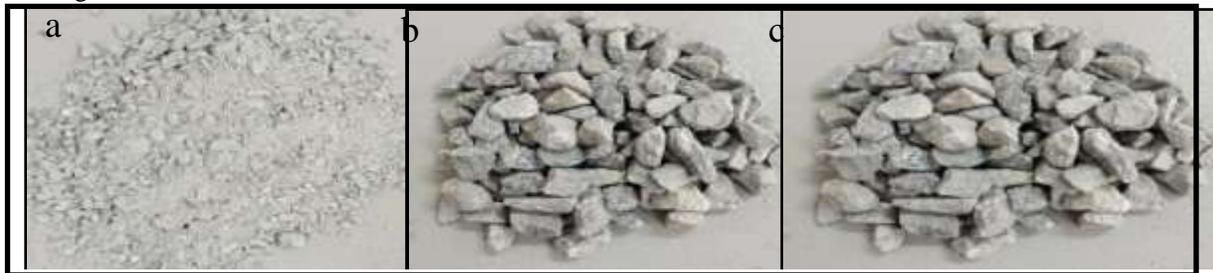
**Figure 1:-** a) Sable 0/6    b) Gneiss concassé 6/10    c) Gneiss concassé 10/14
