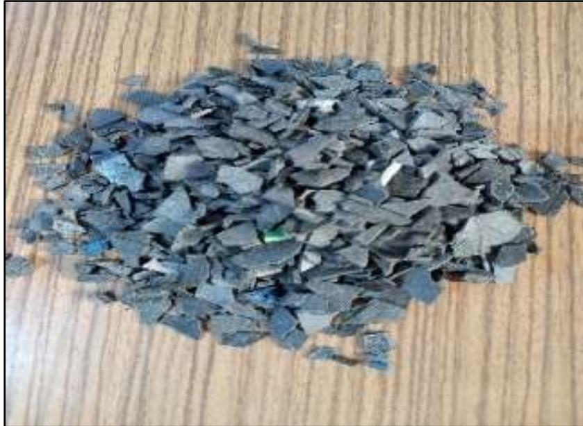
**Figure 2:-** Plastiques recyclés du type polypropylène (PP).
