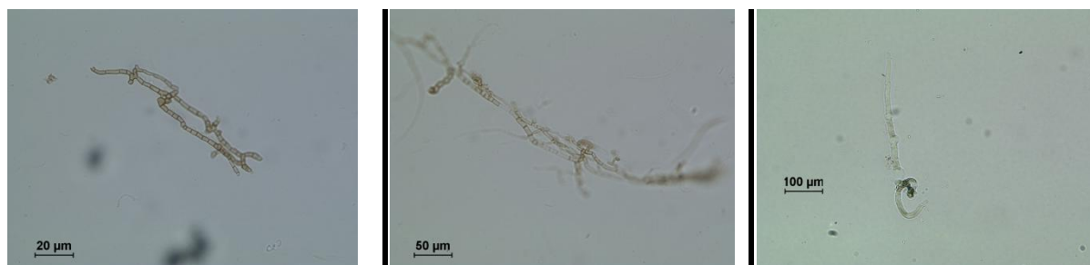
Fig. 1. Gonflement des fibres de lin dans EMIMAC/DMSO
